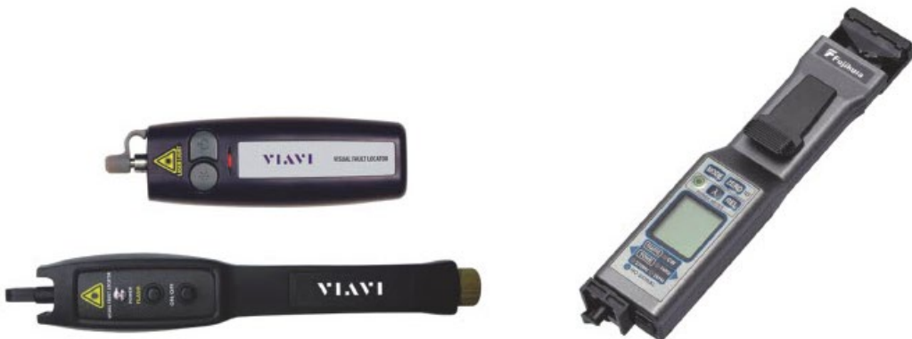
Kuva 9.16. Näkyvän valon laser (vasemmalla) ja liikenteentunnistin (oikealla).
