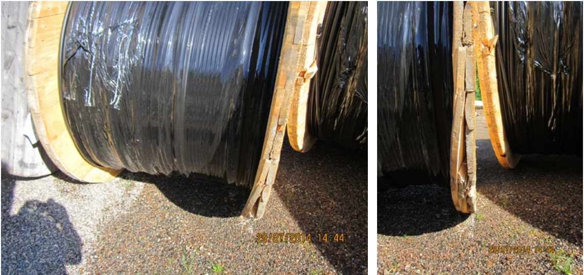
Kuva 7.2. Esimerkki pudotuksessa vaurioituneesta kelasta (Kuvat: Voimatel Oy).
