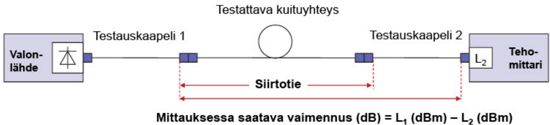
Kuva 9.14. Vaimennuksen mittaus. Kuvasta käy myös ilmi, miltä osuudelta vaimennuksen mittaustulos saadaan, jos vertailuteho L_1 on mitattu yhden testauskaapelin menetelmällä.
