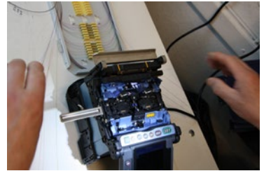
Jatkettu kuitu siirretään kuitujatkoskoneen uuniin.
