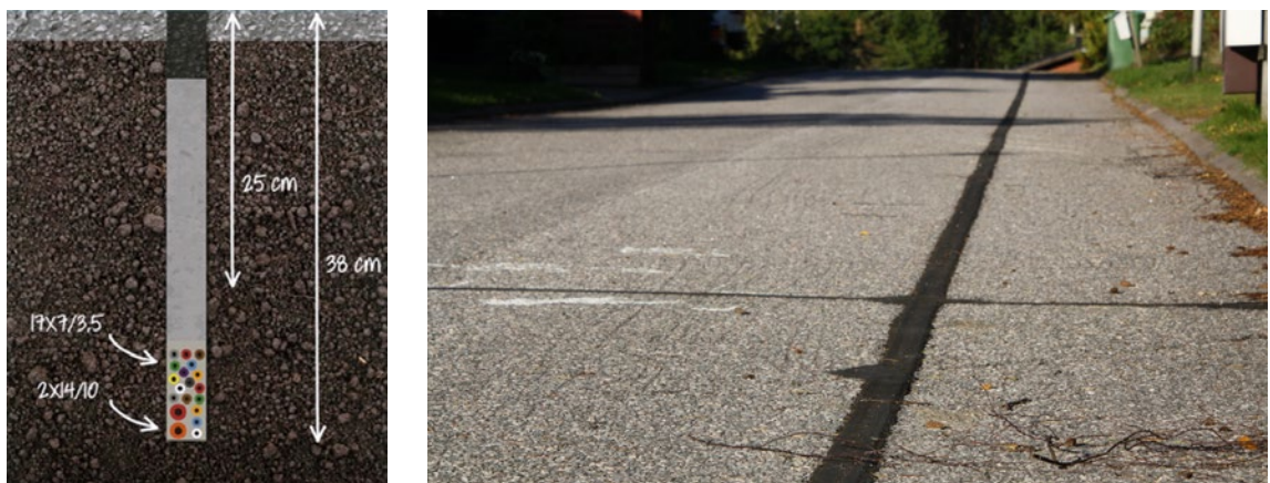
Kuva 7.19. Mikro-ojituksen periaate ja esimerkki pintajäljestä uutena (Kuvat Suomen Kuitusahaus Oy ja Nestor Cables Oy)
