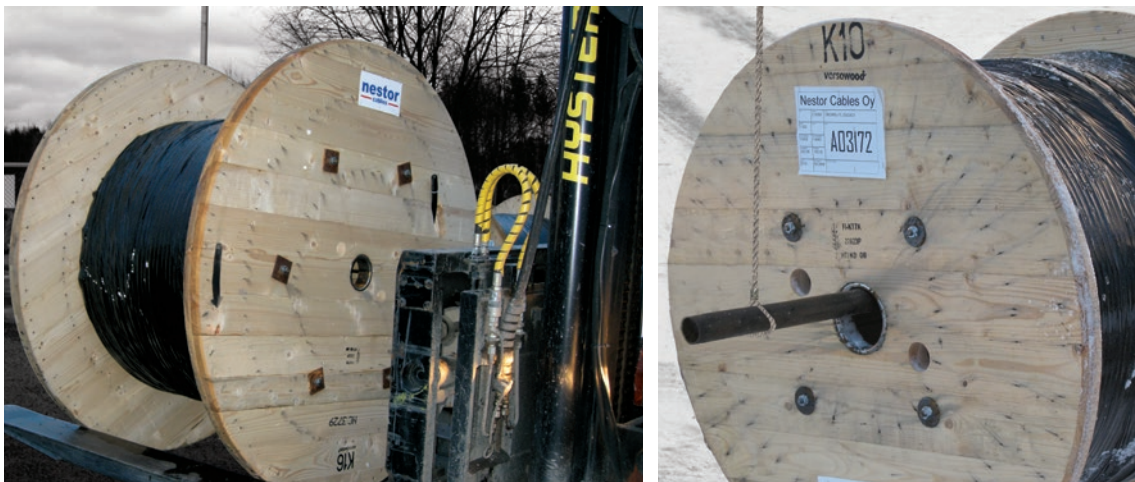
Kuva 7.1. Kaapelikelan käsittelyä trukilla ja nosturilla (Kuvat: Nestor Cables Oy)
