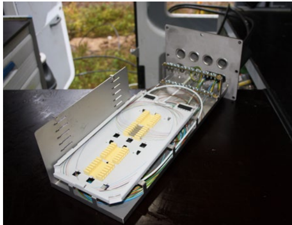
Kuva 8.10. Kylkioton periaate ja toteutus (Kuvat: Nestor Cables Oy)
